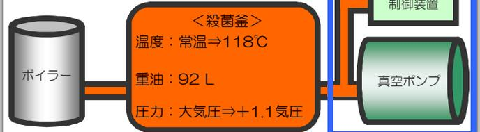
従来は釜内の空気を追い出すために蒸気を垂流していましたが、高圧真空殺菌システムでは蒸気の垂流しをゼロにし、高効率殺菌処理を実現しました！
