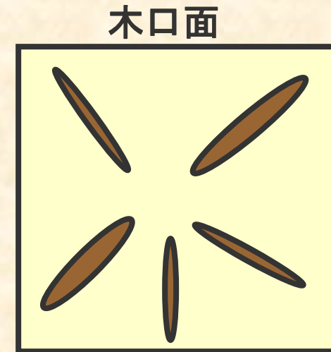
図5.木口面の内部割れ
